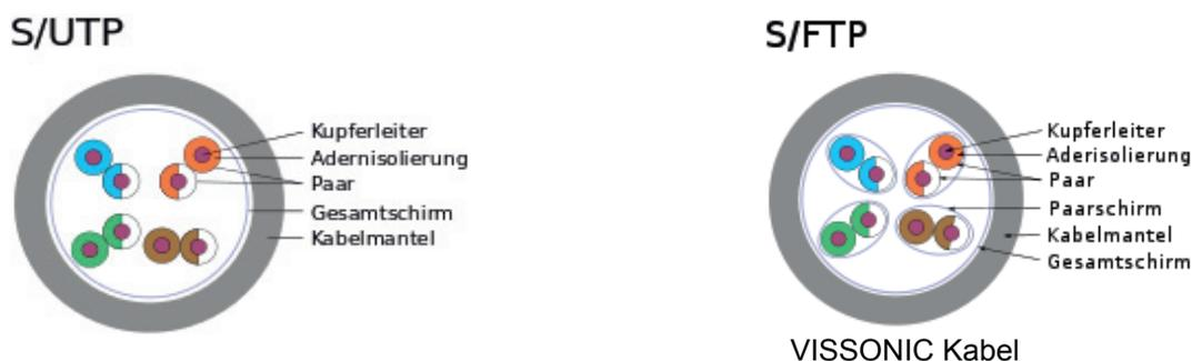
Bei der Auslegung von Netzwerken für PoE-Anwendungen ist daher der von der Länge der Twisted-Pair-Kabel abhängige Spannungsabfall (auch als Spannungsfall bezeichnet) zu berücksichtigen. Kabel mit größerem Leitungsquerschnitt sind aufgrund der kleineren Widerstände von Vorteil. Die Kodierung der Leiterquerschnitte erfolgt i. d. R. durch eine Bezeichnung gemäß American Wire Gauge auf den Netzkabeln. VISSONIC verwendet CAT5e Netzkabel mit der Kodierung AWG24.
